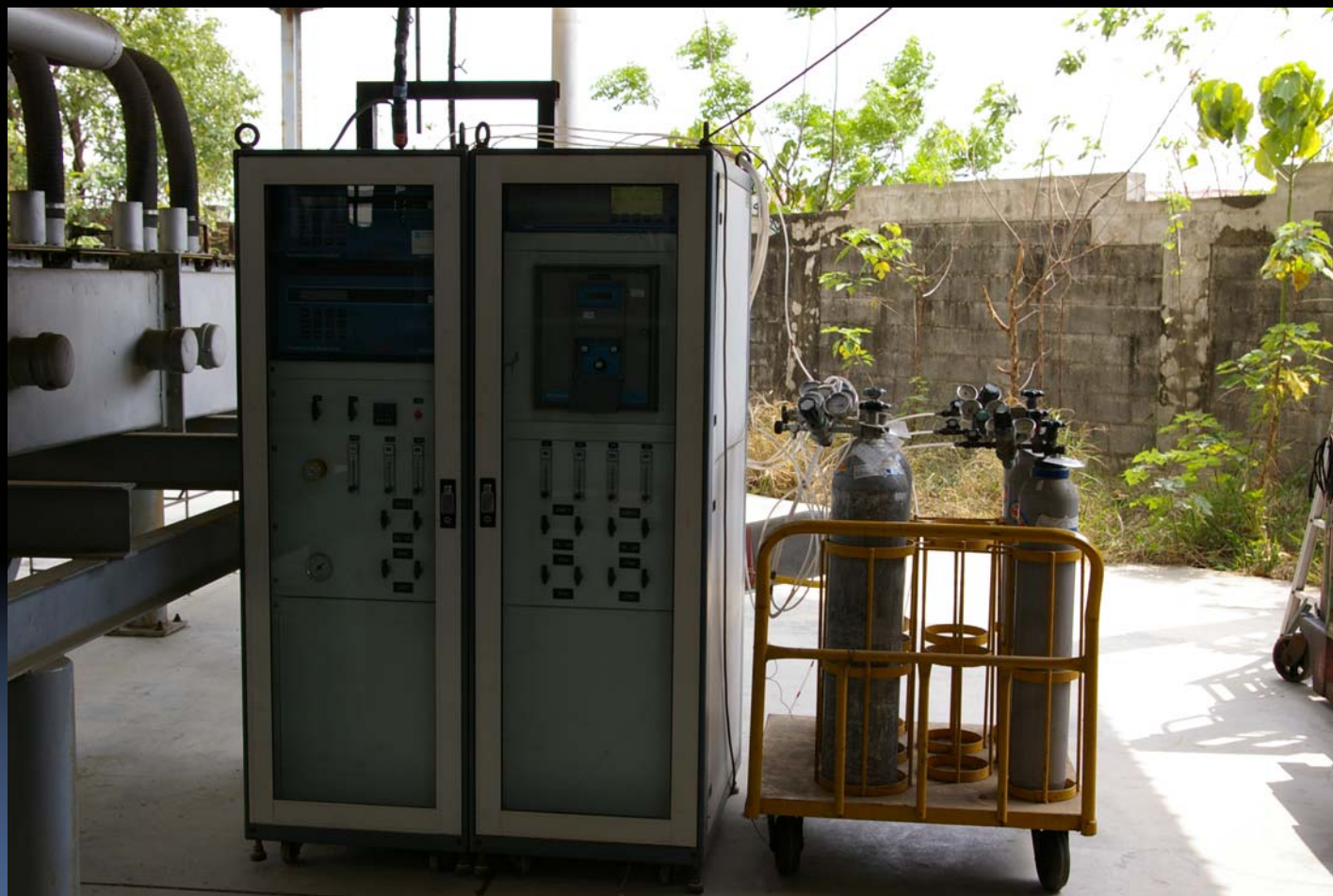
空氣污染排放物測試設備
